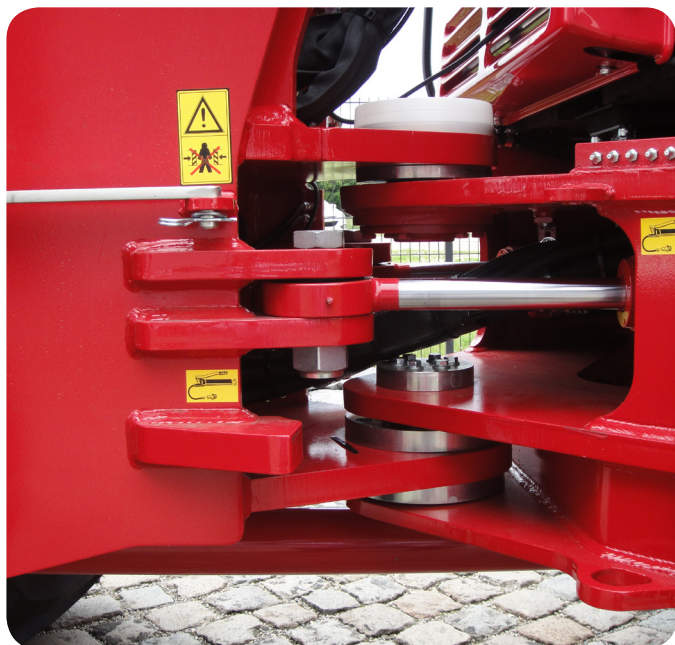
Toutes les chargeuses Schaffer disposent d'une articulation centrale qui offre de nombreux avantages, dont une extrême maniabilité.
